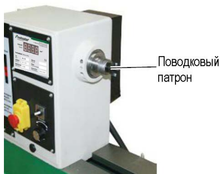
Рис. 13: Установка поводкового патрона
