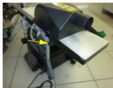
Рис. 12: Монтаж вытяжного колпака для стружки
