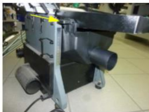
Рис. 8: Монтаж вытяжного колпака для стружки
