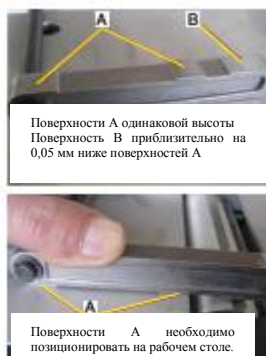
Рис. 14: Регулировка строгального ножа на поверхности В
