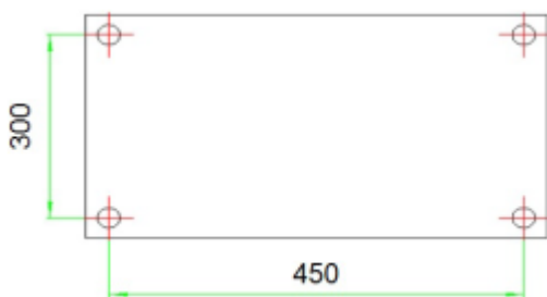
Рис. 6: Расстояния между отверстиями ADH 250
