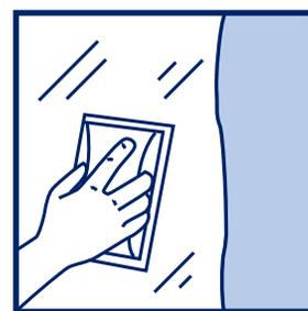
Выравниваемая поверхность хорошо шлифуется без образования царапин благодаря оптимальному размеру частиц наполнителей. Шлифовку поверхности производить после высыхания последнего слоя.
