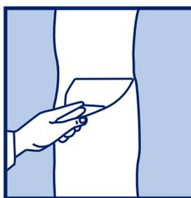
Готовую шпаклевочную смесь наносят на поверхность при помощи шпателя ровным слоем толщиной до 2-х мм. Перед нанесением следующего слоя необходимо убедиться в том, что предыдущий слой высох. Время высыхания зависит от толщины слоя, влажности и температуры.
