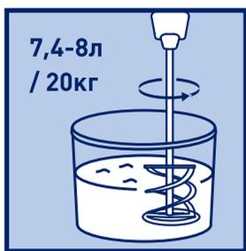
Сухую смесь высыпать в ёмкость с чистой водой температурой от +15 до +18 °C в соотношении 0,37-0,40 л на 1кг смеси (7,4-8,0 л на мешок 20 кг) и тщательно перемешать при помощи дрели с насадкой до получения однородной массы без комков, дать выстояться в течение 15-20 мин и перемешать вторично. Полученную растворную смесь можно использовать в течение 24-х часов. В процессе работы необходимо периодически перемешивать растворную смесь.
