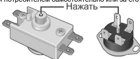
Рисунок 5. Возможные схемы расположения кнопки термовыключателя
