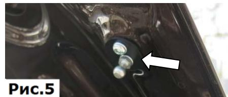
5. Расположить болт-шарнир вдоль капота ниже винта M6x16. Сместить шайбу до упора вверх и влево (в сторону моторного отсека), (Рис. 4). Придерживая болт-шарнир, затянуть винт M6x16 шестигранным ключом №4. Далее затянуть болт-шарнир ключом №10 с усилием 6 Нм, (Рис.5).
