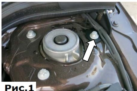
1. Открутить болт крепления опоры передней подвески. Установить кронштейн опоры. Плотно прижать боковую сторону кронштейна к кузову автомобиля. Затянуть болт торцевой головкой TORX E14 с усилием 50 Нм, (Рис.1).
