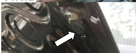
2. Снять указанную заглушку в усилителе капота, (Рис.2)
