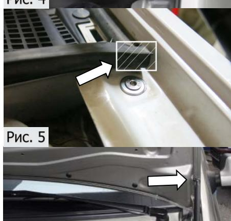
5. Отрезать поперечный уплотнитель жабо по 25 мм с обоих торцов, (Рис.5).
