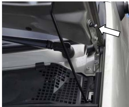
4. Торцевой головкой №10 выкрутить верхний болт крепления капота. Установить вместо него болт-шарнир S12 с шайбой 6. Затянуть болт-шарнир торцевой головкой №12 с усилием 9 Нм, (Рис.4.).
