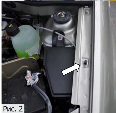
2. Установить болт-шарнир S10 с шайбой 6. Затянуть болт-шарнир S10 высокой торцевой головкой №10 с усилием 9 Нм, (Рис.2).
