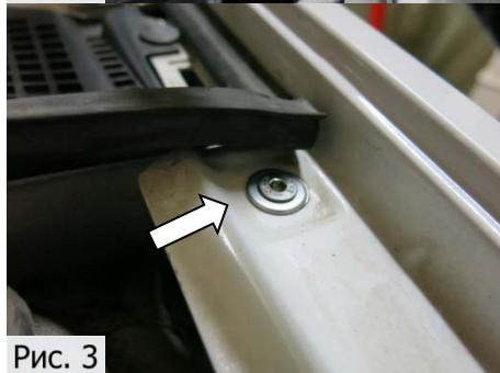
3. Заменить второй болт крепления крыла (ближний к лобовому стеклу) на винт M6x16 с шайбой 6. Затянуть винт M6x16 вставкой-битой HEX4мм с усилием 9 Нм, (Рис.3).
