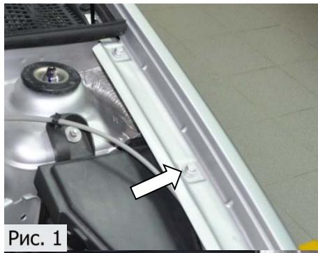
1. Торцевой головкой №10 открутить болт крепления крыла, (Рис.1).
