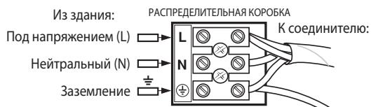
Подключение к распределительной коробке, расположенной на кронштейне, следует выполнить в соответствии с приведенной выше диаграммой.
