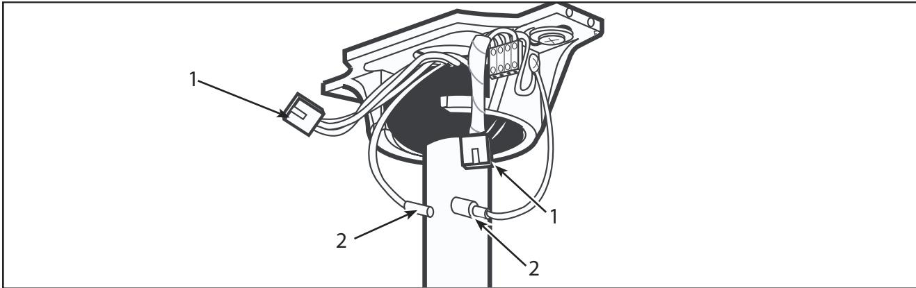
Закрепив блок вентилятора на кронштейн, вставить штексерную розетку (1) вентилятора в распределительную коробку. Прикрепить заземляющий провод (2) стержня к кронштейну.
