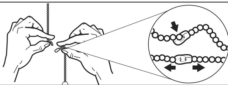
Прикрепить декоративную подвеску и удлиняющую цепь, находящиеся в пакете с деталями, к цепям вентилятора и осветительного прибора (факультативно), введя конец цепи в цепное соединение. Проверить надежность установки, слегка потянув за обе цепи в месте соединения.
