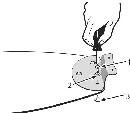
Привинтить кронштейны лопастей к лопастям, используя винты кронштейнов лопастей (1), шайбы из ткани (2) и декоративные гайки (3).
