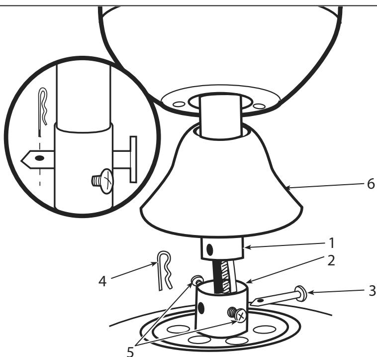
Вставить стержень (1) в соединитель стержня (2). Убедиться в том, что отверстия стержня и соединителя стержня находятся на одной линии. Вставить поперечный штифт (3) в соединитель и стержень. Вставить штырь с отверстиями для крепления (4) в поперечный штифт таким образом, чтобы он защелкнулся. Затянуть стопорные винты (5) в соединителе. Надеть крышку соединителя (6) на соединитель стержня.
