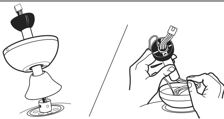
Пропустить стержень через консоль и крышку соединителя. Аккуратно пропустить электропровода и штепсель через комплект стержня и шарика.
