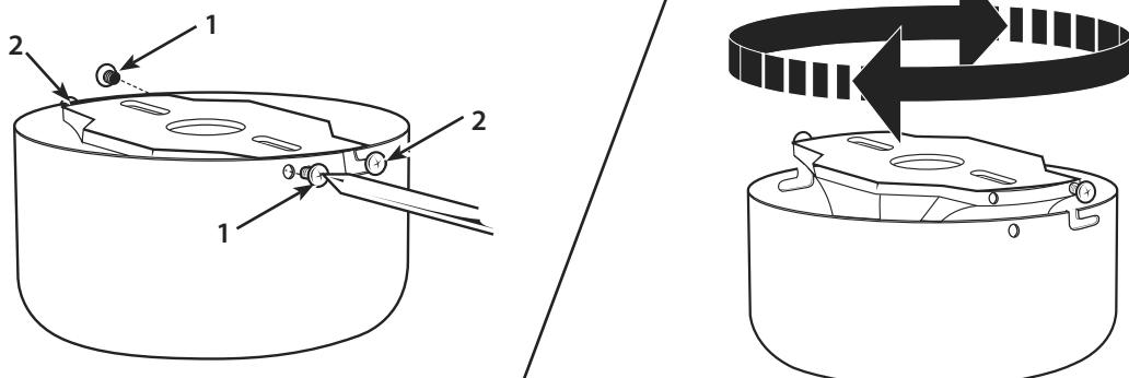
Вынуть винты из двух соединительных отверстий (1), расположенных на консоли. Ослабить (не вывинчивая) винты, находящиеся в соединительных пазах (2), расположенных на консоли. Повернуть кронштейн и снять его с консоли.
