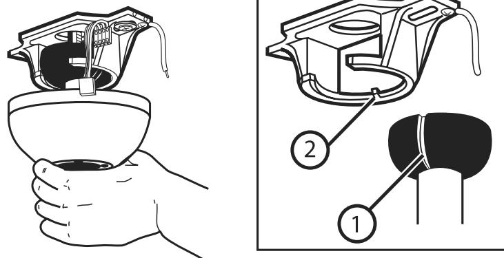
Аккуратно поднять вентилятор и установить его на кронштейне. Поворачивать вентилятор до тех пор, пока выступ (2) кронштейна не войдет в выемку на шарике стержня (1). Таким образом, можно будет осуществить подключение вентилятора, не поддерживая его вручную.
