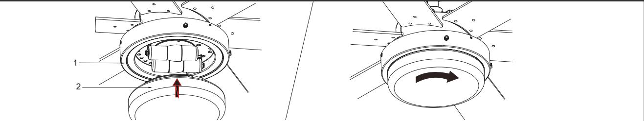
Найдите углубления на горловине стеклянного абажура и совместите их с выступами, расположенными внутри светильника. Поднимите стеклянный абажур вверх, так чтобы выступы вошли в углубления на стекле, и поверните абажур по часовой стрелке, чтобы зафиксировать его.
