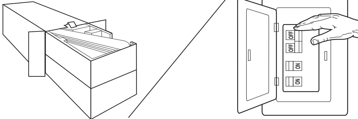
Следует распаковать вентилятор и тщательно осмотреть его, проверив наличие всех деталей. Во избежание удара током, следует отключить блок предохранителей.
