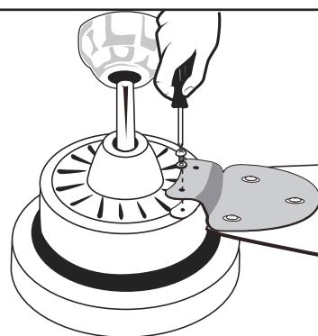
Прикрепить комплект лопастей к мотору с помощью предусмотренных для этого винтов и шайб.
