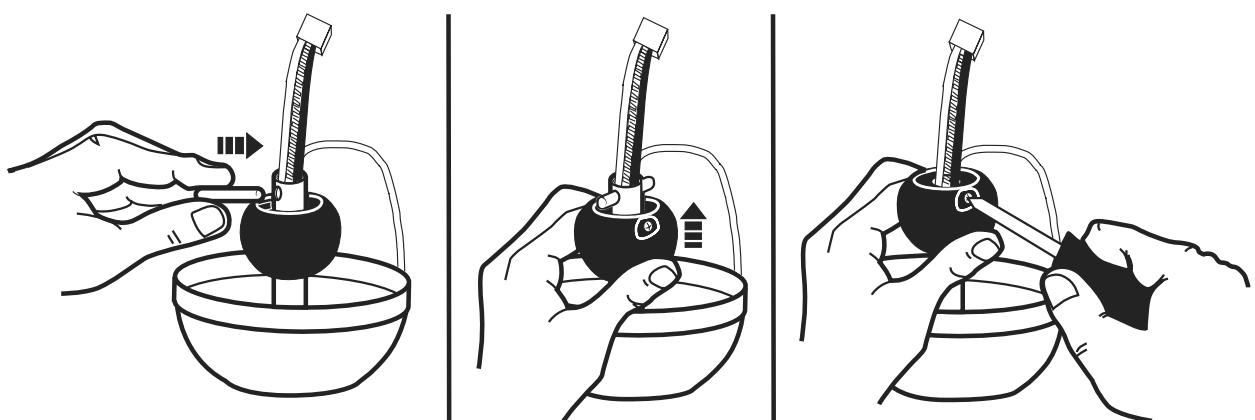
Вновь вставить поперечный штифт в стержень и двигать шарик вверх до тех пор, пока поперечный штифт надежно не войдет в него. Затянуть стопорный винт шарика.
