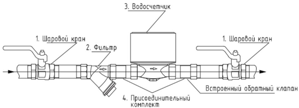
1. Перед монтажом счетчика следует удалить пластиковые предохранительные колпачки с патрубков счетчика.
