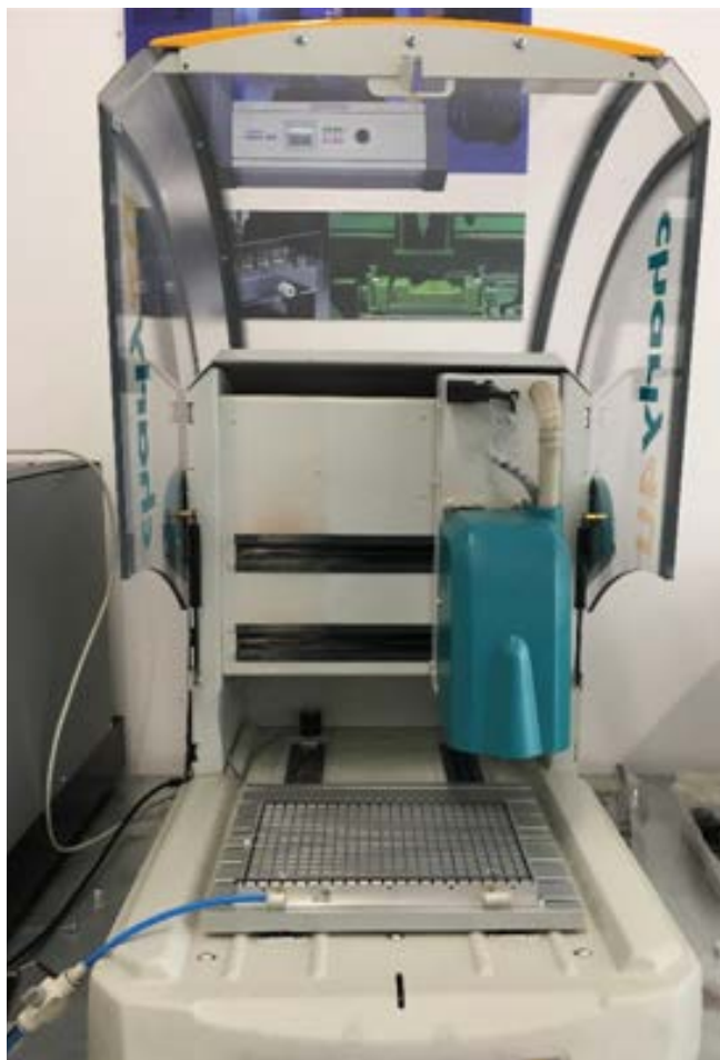
Станок Charly Robot 4U, оснащенный вакуумным столом
