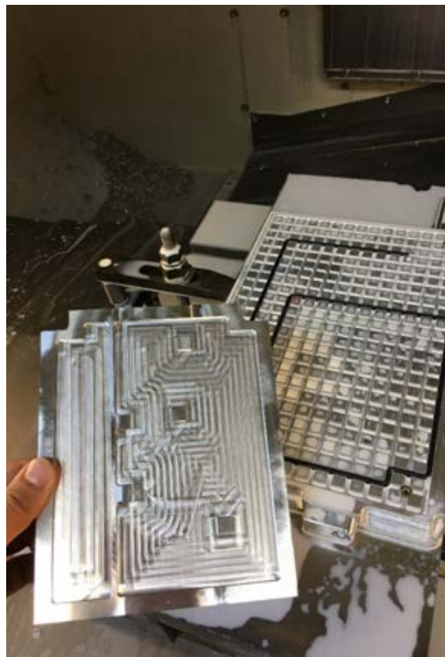
Алюминиевая крышка, обработанная на вакуумном столе
