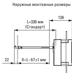
Рисунок 9г - Монтажные размеры при установке на дверцу шкафа для рубильников 400-630 А
