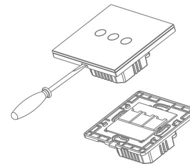
1. Аккуратно вставьте отвертку в паз передней панели устройства и снимите переднюю панель
