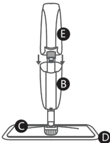
Перед началом эксплуатации наполните контейнер (Е) водой. Открутите крышку контейнера и залейте обычную водопроводную воду. Вы можете добавить в воду моющее средство.
