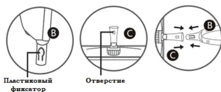
Выровняйте удлинительную трубку относительно основания швабры так, чтобы пластиковый фиксатор на трубке и отверстие на основании швабры находились на одной линии, и вставьте трубку в основание, при этом должен раздаться щелчок.
