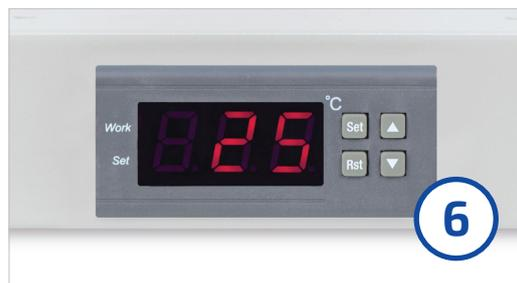
Далее с помощью клавиш **▲** или **▼** необходимо установить нужную температуру и нажать кнопку **Rst** один раз, после чего индикатор погаснет.
