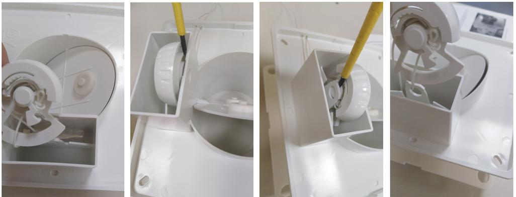
Последовательное извлечение регулирующего механизма из посадочного места.
