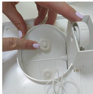
Установка регулировочного механизма на место (в центре), проверка совпадений положений механизма и заслонки – открыто (слева) и закрыто (справа).
