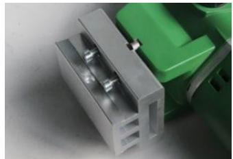
5.2.3 При использовании вакуумного основания для крепления стойки сверла убедитесь, что разрежения достаточно (минимум -0,8 бар), и прокладки не изношены.
