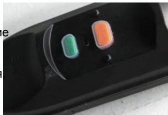
5.5.3 Никогда не кладите ПУЗО в воду. Перед началом работы проверьте правильность функционирования, нажав кнопку TEST на ПУЗО. Никогда не работайте с алмазным сверлом без УЗО или ПУЗО непосредственно от источника питания.
