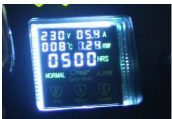
6.2.3 Помимо красного индикатора, DMP-352 оснащен ЖК-дисплеем. Он покажет силу тока в реальном времени. Когда электроинструмент находится в состоянии перегрузки по току, на дисплее загорается значок перегрузки по току вместе с красным светодиодом и предупреждением ALARM.
