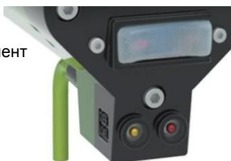
6.2.2 Когда горит красный свет, срабатывает защита от перегрузки по току и мотор немедленно выключается. Перед повторным запуском мотора необходимо провести полную проверку, и электроинструмент должен быть разряжен. В противном случае это может повредить мотор и / или привести к опасной ситуации.
