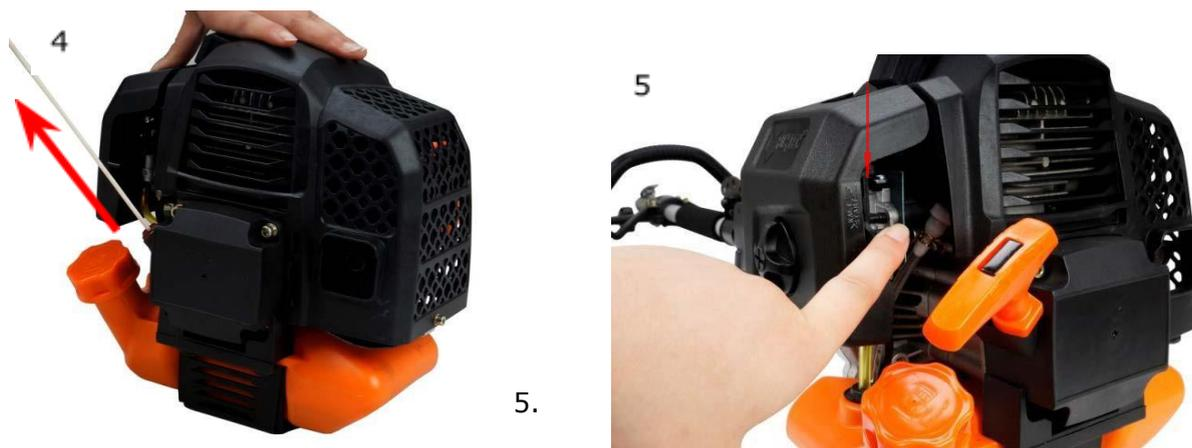
**Важно:** Как только двигатель откликнется, установите рычаг дроссельной заслонки в положение «WARM START» и опять потяните ручку стартера, пока двигатель полностью не запустится.
