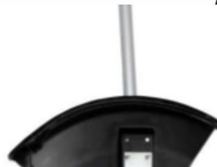
1. Вставьте металлический стопорный стержень (1) в отверстие в чашке редуктора.
