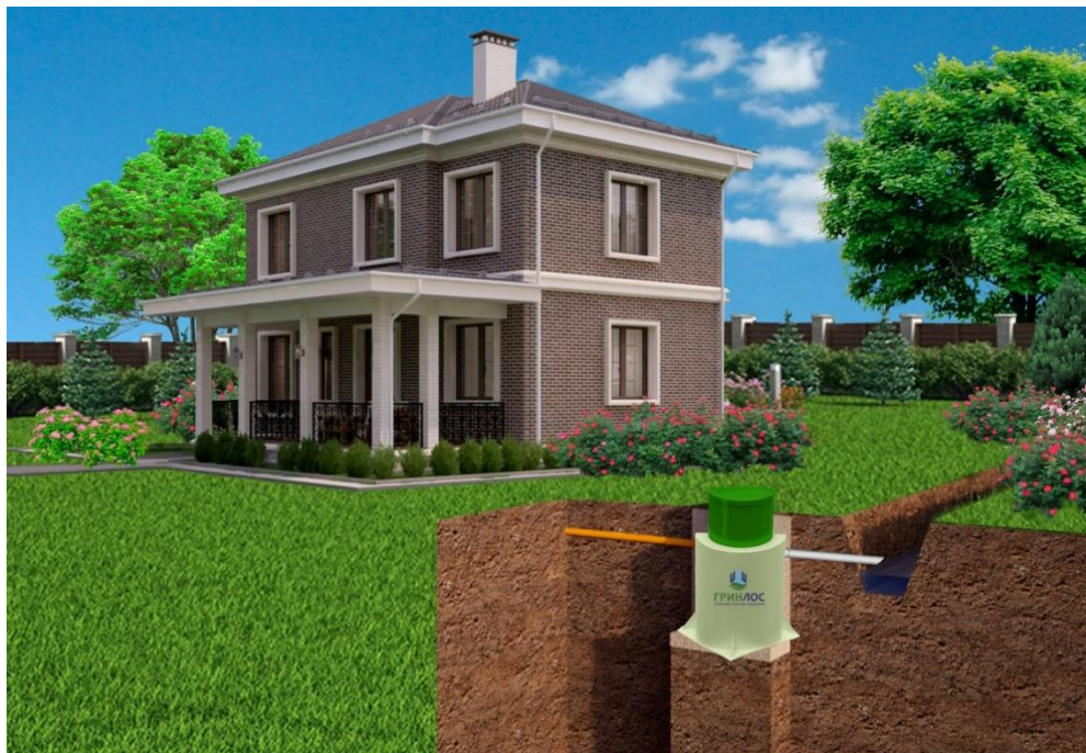
Рисунок 13. Монтаж с самотечным отводом очищенных сточных вод в дренажную канаву
