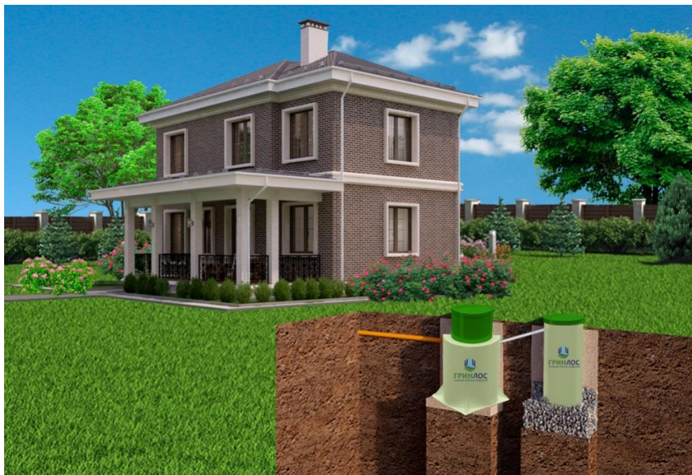
Рисунок 18. Монтаж с принудительным забором воды в фильтрующий колодец (Модели со стандартной высотой корпуса)
