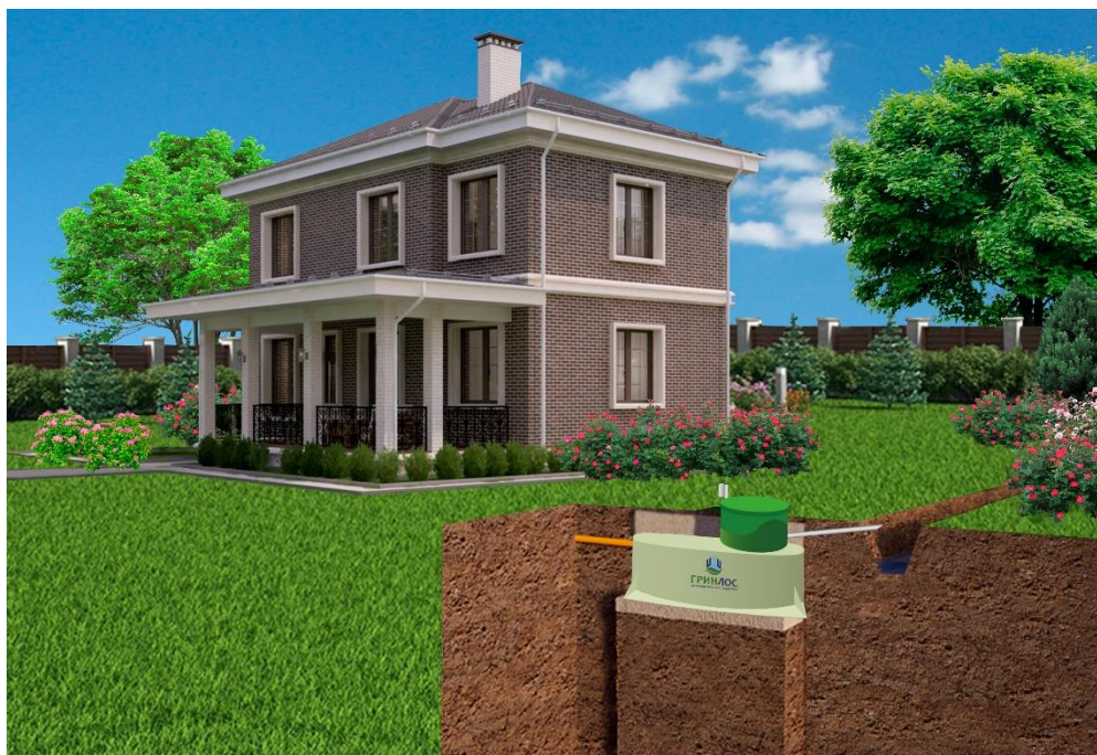
Рисунок 17. Монтаж с принудительным отводом сточных вод в дренажную канаву (Модели с низким корпусом)
