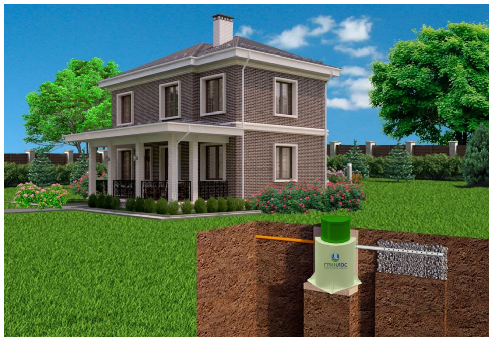
Рисунок 14. Монтаж с отводом очищенных сточных вод в дренажный элемент.
