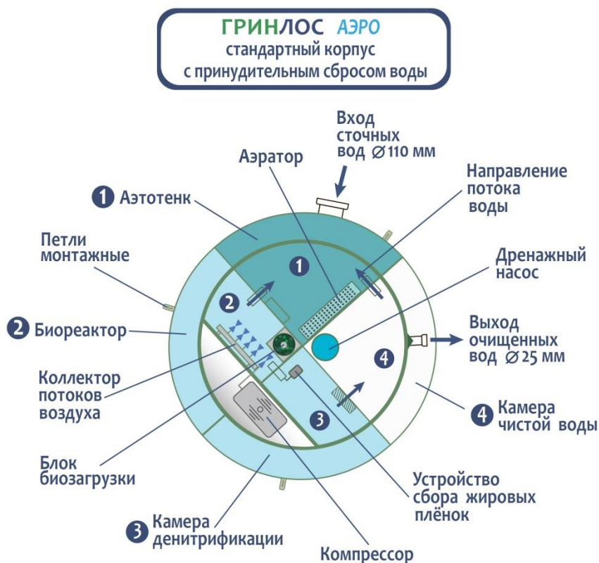
Рисунок 6. Технология очистки стоков в моделях со стандартным корпусом и принудительным сбросом
