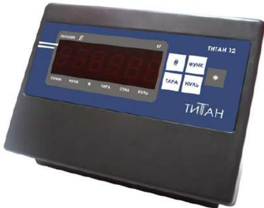
Универсальный весовой прибор для различного вида весов. IP53 6-ти разрядный LED дисплей(высота цифр 20мм). Класс точности С3. В стандарте: RS232, токовая петля 20mA, встроенная батарея 6V. БЕСПЛАТНОЕ ПО.
