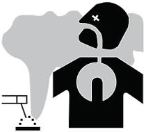
Выделяемые при сварке дым, газ и пыль опасны для здоровья. Вентиляция должна быть достаточной, и может потребоваться дополнительная подача воздуха. При недостаточной вентиляции можно воспользоваться маской сварщика-респиратором. Проверьте, чтобы всасывание воздуха было эффективным в соответствии с нормами безопасности.
