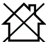
Это оборудование класса А не подходит для использования в жилых кварталах, где электрический ток подается общественной системой питания низкого напряжения. В таких кварталах могут возникнуть трудности обеспечения электромагнитную совместимость из-за кондуктивных и индуктивных помех на радиочастоте.
