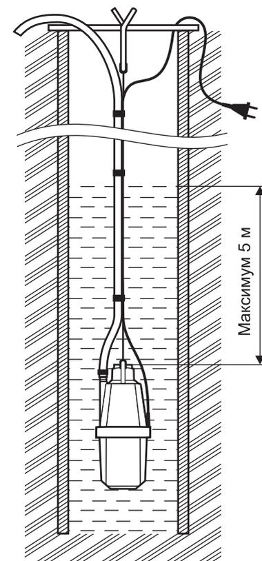
**Рисунок 2** — Установка и монтаж насоса в колодце
