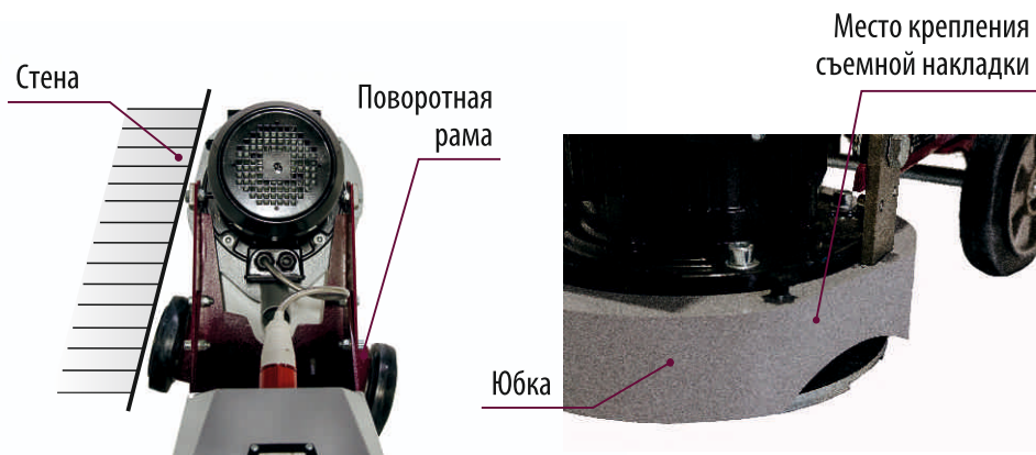
Рис. 2 Шлифовка вдоль стен
