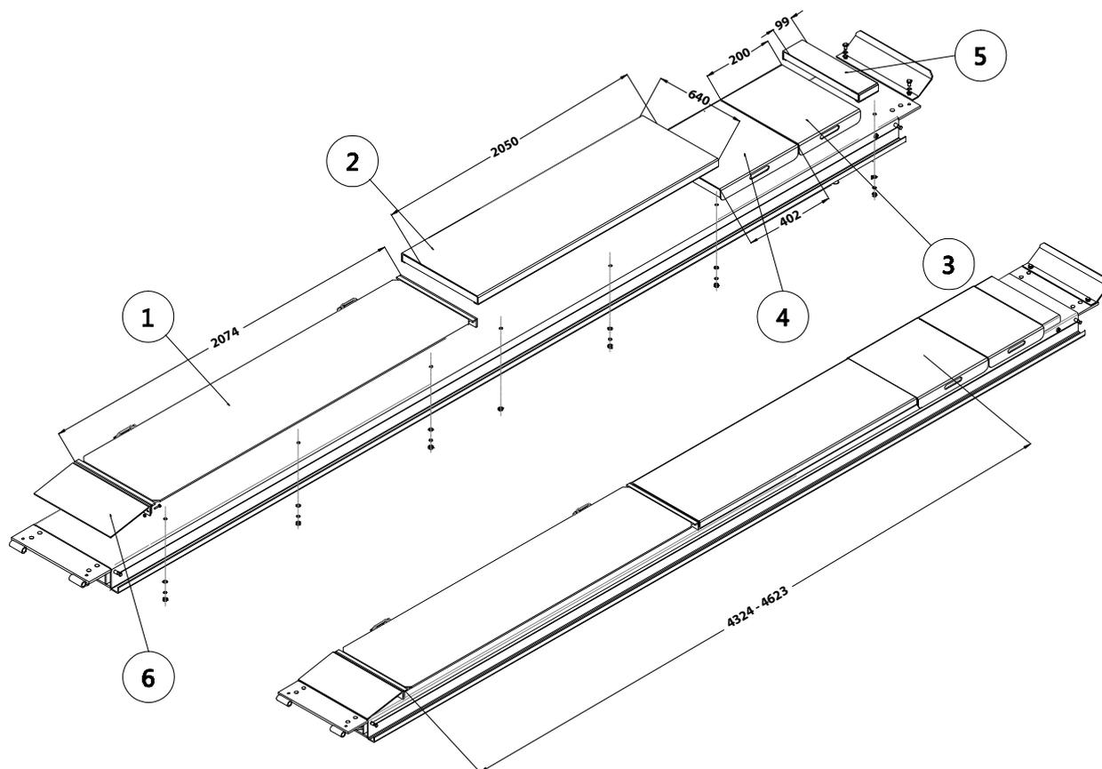
\* Расстояние от начала скользящей платформы до центра поворотного круга (зависит от положения поворотного круга) - **4324 – 4623 мм**
