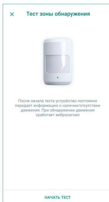
Рисунок 9.5 – Тест зоны обнаружения датчика в приложении
