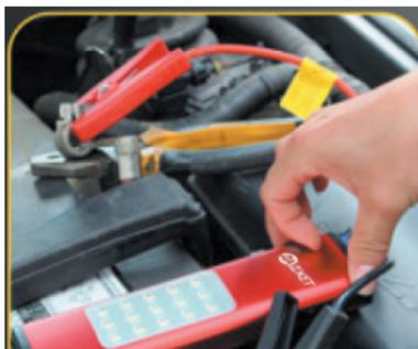
1. Подключите провода к аккумулятору автомобиля
