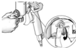
9. Снимите заглушку и используйте маленькую отвертку, чтобы удалить все компоненты из передней части краскораспылителя.
