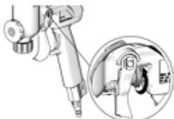
5. Используя маленькую плоскую отвертку, отсоедините стопорное кольцо со штифта спускового механизма. Снимите штифт, шайбу и спусковой механизм.
