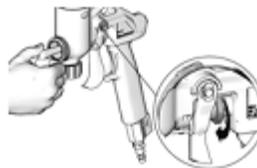
6. Вставляя иглу в краскораспылитель, поверните регулировочную гайку против часовой стрелки, чтобы затянуть иглу.
