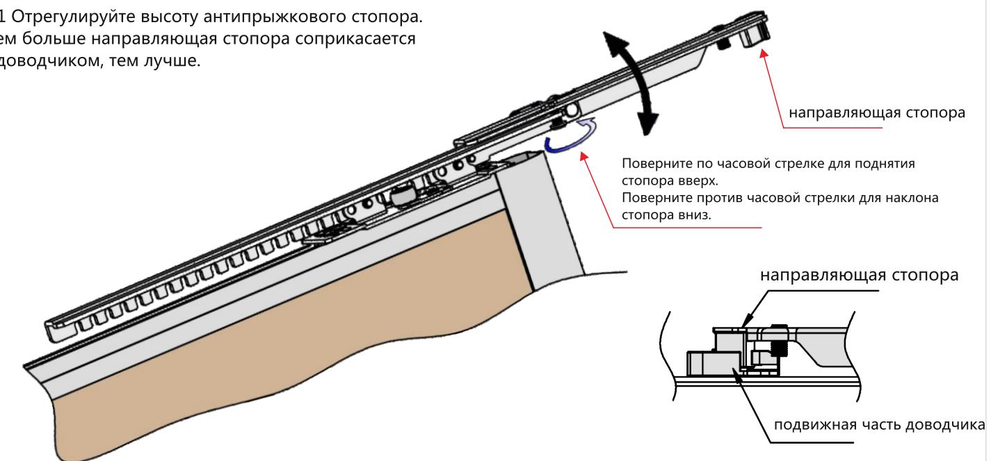
4.2 Отрегулируйте высоту анти-прыгающего ролика, пока дверь не будет плавно двигаться.
