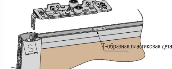
2.3 Измерьте размер S, закрепите основную часть со стопорным соединителем в доступном положении.
