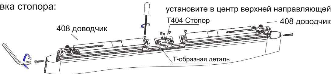
1.1 В первую очередь установите пластмассовую деталь Т-образной формы в верхний горизонт двери.
