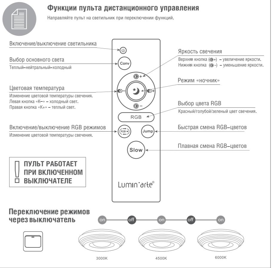
**ПУЛЬТ РАБОТАЕТ ПРИ ВКЛЮЧЕННОМ ВЫКЛЮЧАТЕЛЕ**
