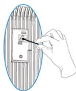
После снятия пылезащитного чехла слегка протрите линзы датчика ватным тампоном
