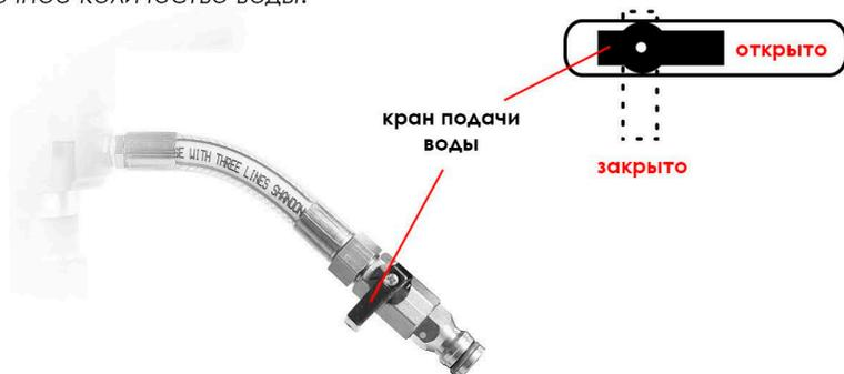
Помимо охлаждения, вода вымывает из зоны сверления (бурения) абразивные частицы, образующиеся в процессе бурения (шлам).
