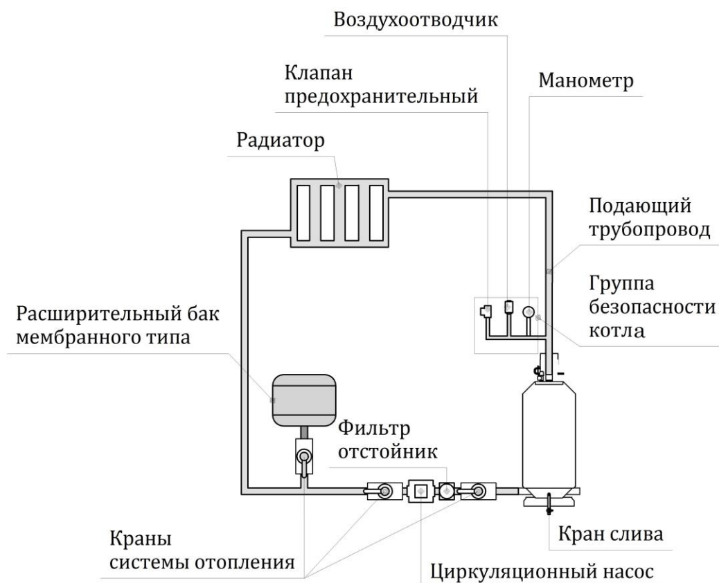
Рисунок 8 – Схема закрытой системы отопления с принудительной циркуляцией
