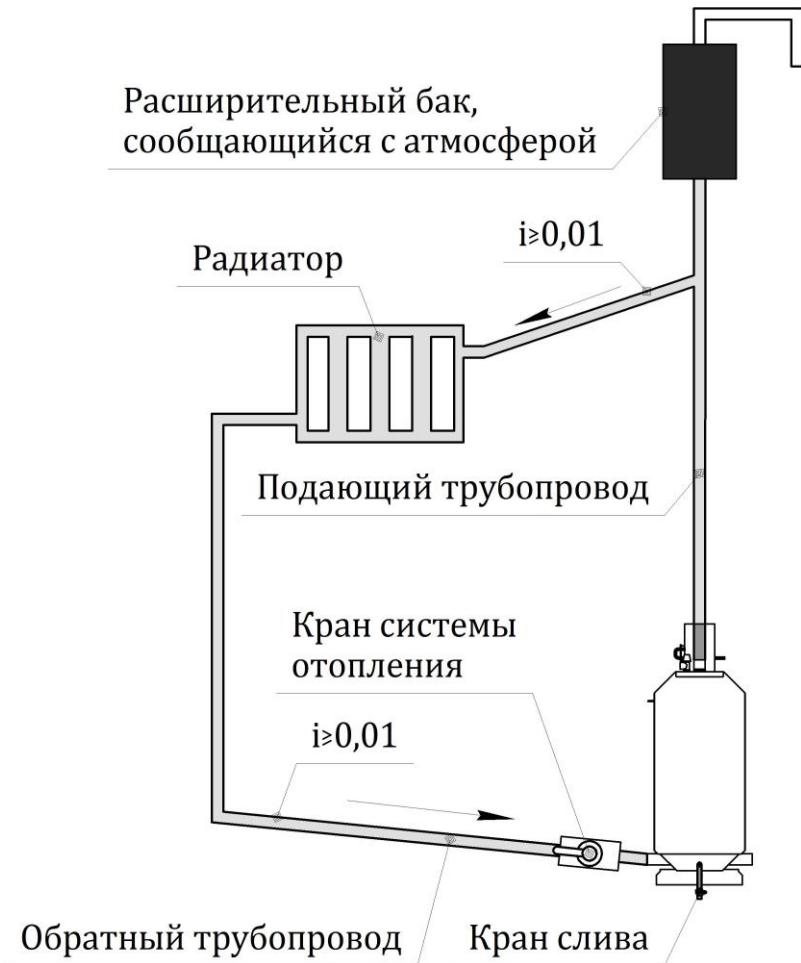
**Рисунок 13 – Схема открытой системы отопления с естественной циркуляцией**
