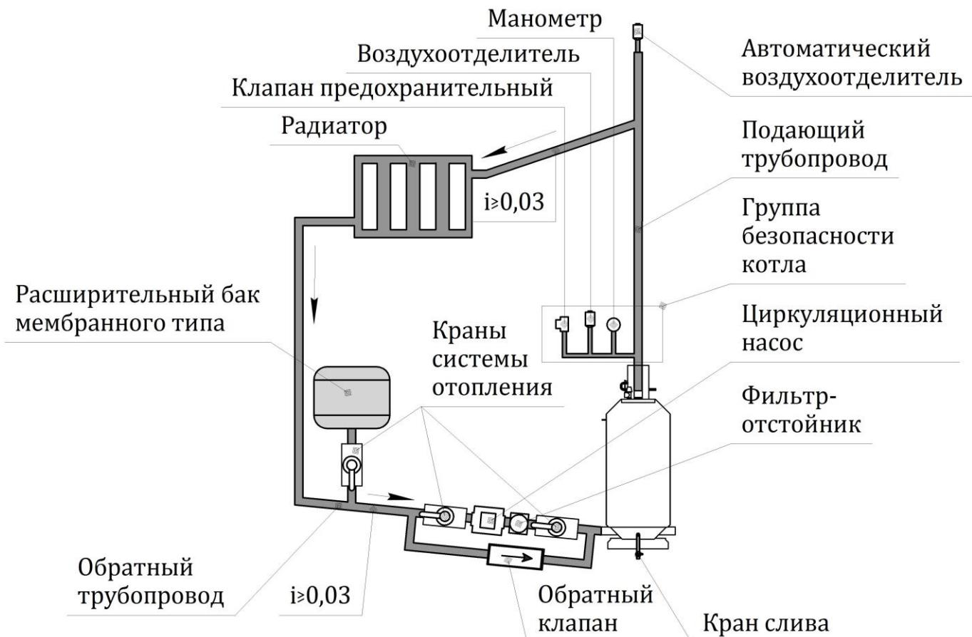
**Рисунок 15 – Схема закрытой системы со смешенной циркуляцией**
