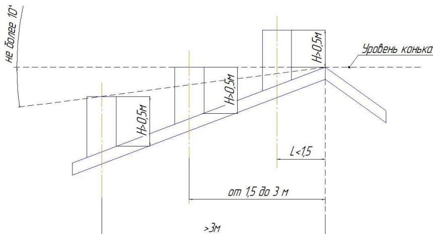
**Рисунок 11 – Варианты расположения трубы на скате**
