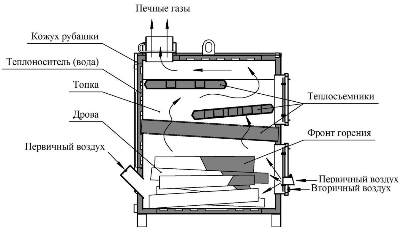
Рисунок 2 – Схема КОД-63, КОД-80, КОД-100
