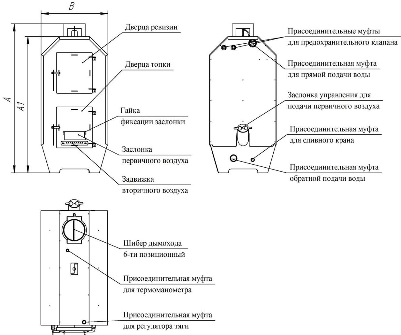
**Рисунок 4 – Общий вид и оснащение котла**
