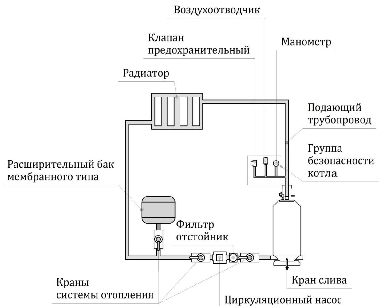
**Рисунок 14 – Схема закрытой системы отопления с принудительной циркуляцией**
