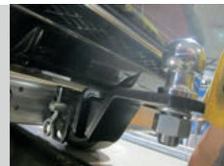
Тип соединения: шаровый; Тип шара «Е»; Диаметр сцепного шара: 50 мм.; Масса комплекта TCU LRX991102: 24,2 кг.
