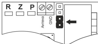
**ВНИМАНИЕ!!! Для данного режима сохраняется состояние реле при отключении электричества. Т.Е. если реле было включено, и отключилось питание, то при восстановлении питания реле включится.**
