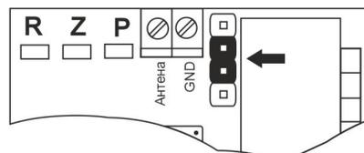
3) Режим «переключателя» - при получении сигнала реле включается, светодиод начинает светиться. При получении повторного сигнала реле выключается, светодиод гаснет. Чтобы установить данный режим, нужно установить одну перемычку в позицию как показано на рисунке:
