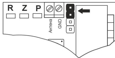
2) Режим «1 минута» - при получении сигнала от пульта реле включается, светодиод загорается, через 1 минуту реле выключается, светодиод гаснет. При повторном получении сигнала таймер работы запускается заново. Чтобы установить данный режим, нужно установить одну перемычку в позицию как показано на рисунке:
