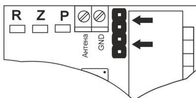
**ВНИМАНИЕ!!! Для данного режима сохраняется состояние реле при отключении электричества. Т.Е. если реле было включено, и отключилось питание, то при восстановлении питания реле включится.**
