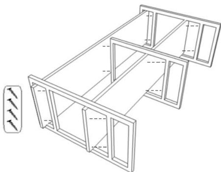
**Шаг 1 Бервин:** Разместите каркас на горизонтальной поверхности. Поместите полки на каркасе (полки должны выступать по бокам каркаса на 2,5см с каждой стороны, левая внутренняя стойка должна отступать от боковой стойки на 31см, правая внутренняя стойка должна отступать от левой на 85см). Закрепите полки саморезами 4,2\*35 мм в местах соединения с каркасом
