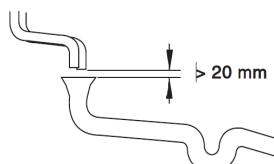
**⚠ Если в полу нет сливного трапа, необходимо использовать отдельное предохранительное устройство (напр., Aquastop). С другой стороны, если сточные воды перекачиваются в подъемную систему, она должна быть рассчитана на расход не менее 3 м<sup>3</sup>/ч или 50 л/мин.**
