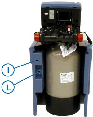
Снова установите колонну умягчителя в солевой бак G, уделяя особое внимание ячейке хлора H (BIO). Перед окончательной установкой умягчителя необходимо определить слив L для перелива и проходное отверстие всасывающей трубы I для рассола, которая будет соединена между клапаном рассола и головкой умягчителя.
