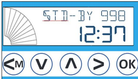
Для программирования функции нажмите кнопку **<M** в течение 3 секунд, затем снова **<M** пока на дисплее не отобразится **STD-BY-Off**, активируйте функцию, нажав **Λ** изменив на **STD-BY-On** подт-
