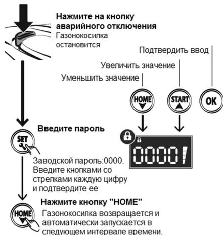
Рис. 16 Выключение газонокосилки в ручном режиме
