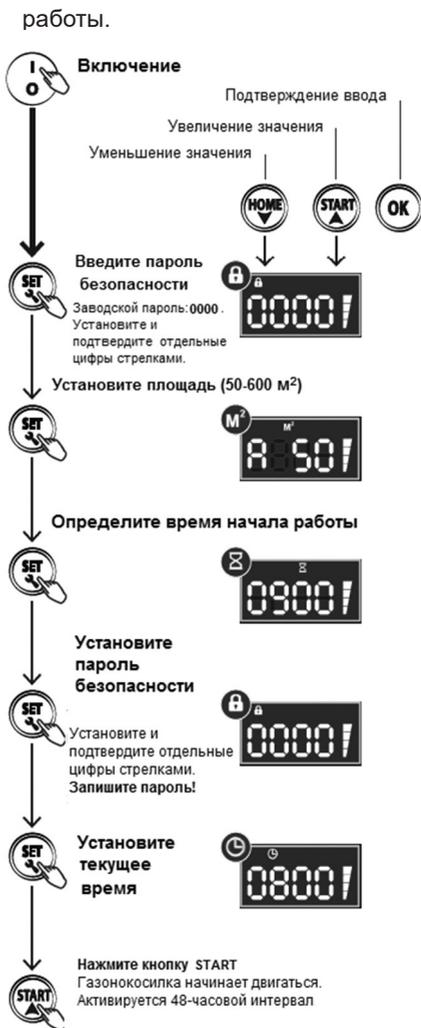
Рис. 17 Алгоритм настройки автоматического режима работы газонокосилки
