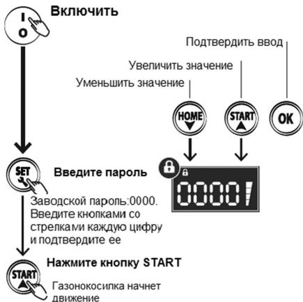
Рис. 15 Включение газонокосилки в ручном режиме
