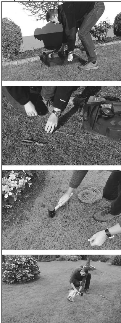
Рис. 7 Последовательность действий при установке зарядной станции
