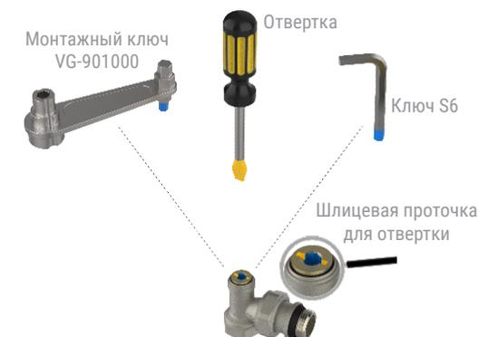
4.6. При монтаже вентиля во время затяжки захват ключом должен производиться со стороны присоединения. Не допускается превышать моменты затяжки, указанные в Таблице №1 п.3.1. настоящего технического паспорта.
