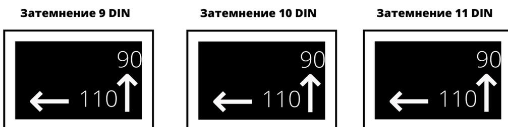
Стандартный светофильтр с фиксированной степенью затемнения, 9,10,11 DIN, размер видимой области 110x90мм.
