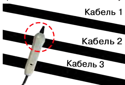
Выбор кабеля по максимальному сигналу
