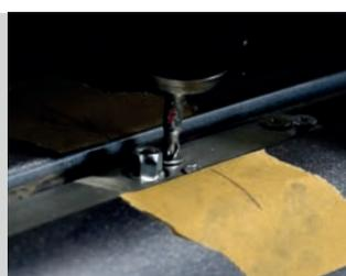
**ШАГ 5.** Установите накладку на место. Установите рейлинг и закрепите его с помощью винтов М6 из комплекта поставки.
