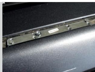
**ШАГ 2.** Приложите рейлинг и выровняйте кронштейны соосно отверстиям в рейлинге. Наклейте кусочки скотча и нанесите разметку соосно гайкам. Измерьте так же расстояние от внутреннего края жёлоба до гайки и запишите.
