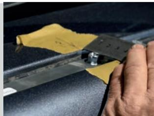
**ШАГ 3.** Снимите кронштейны. Приложите накладку жёлоба на место. Отметьте на жёлобе положение гаек согласно ранее нанесенной разметке. Просверлите отверстия в накладке.
