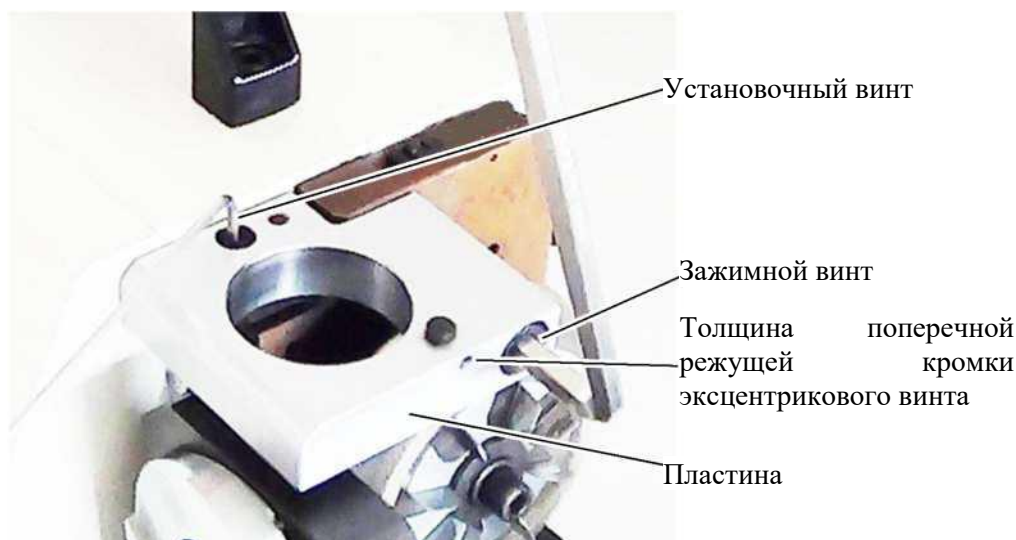
Рис. 4-7. Регулировка уменьшения поперечной режущей кромки
