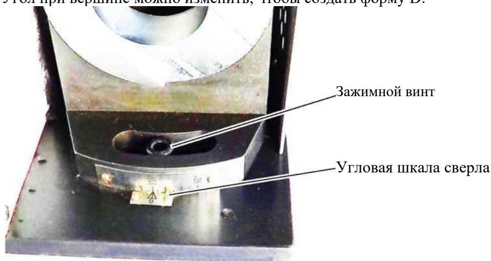
Рис. 4-5. Настройка угла сверла
