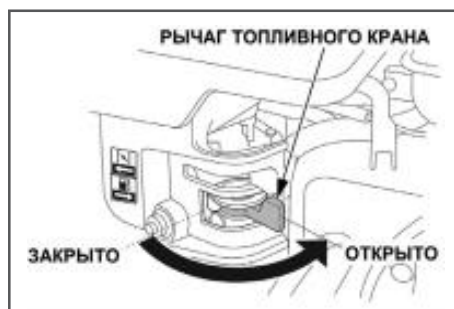
Рис. 16 Рычаг топливного крана Т-60, Т-80, Т-90, Т-100
