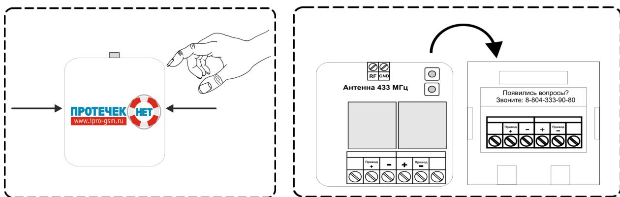
На тыльной стороне крышки устройства показано назначение клеммной колодки прибора, способ запроса показаний датчиков температуры и номер технической поддержки (8-804-333-90-80).
