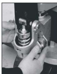
10. Двумя руками нажмите на клапанный кулачок для подъема крюка внутри корпуса и подайте конец цепи в кулачок (см. рисунок ниже).
