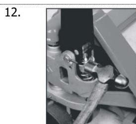
12. **ВАЖНО:** Перед выполнением данного шага проверьте все функции тележки. Для прокачки и удаления воздуха из системы необходимо накачать рукоятку полным ходом. Рычаг подъема следует проверять в самом нижнем положении рукоятки, так как это создает наибольшее натяжение цепи. После регулировки гидравлической тележки убедитесь в том, что она функционирует надлежащим образом, затем вбейте второй пружинный штифт
