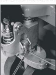
11. Для подъема вил надавите на рычаг несколько раз. Переместите рычаг подъема в НЕЙТРАЛЬНОЕ положение. С помощью ключа на 14 мм и плоской отвертки отрегулируйте клапанный кулачок так, чтобы вилы не поднимались и не опускались (при надавливании на рукоятку) в этом положении.
