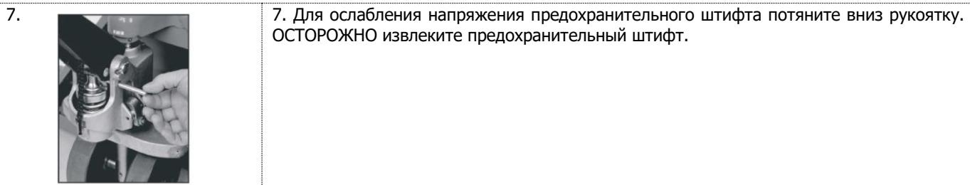
7. Для ослабления напряжения предохранительного штифта потяните вниз рукоятку. **ОСТОРОЖНО** извлеките предохранительный штифт.
