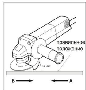
В) С углом в  $15^{\circ}$  до  $30^{\circ}$  к заготовке Вы получите наилучшие рабочие результаты при обдирочном шлифовании. Передвигайте электроинструмент с умеренным прижатием туда и обратно. При этом заготовка сильно не нагревается, не изменяет своей окраски и не остаются канавки. (Рис.6).
