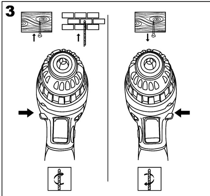
При помощи переключателя направления вращения (В, Рис.1) можно установить направление вращения патрона по часовой или против часовой стрелки. Эта функция позволяет использовать данный инструмент в качестве шуруповерта.
