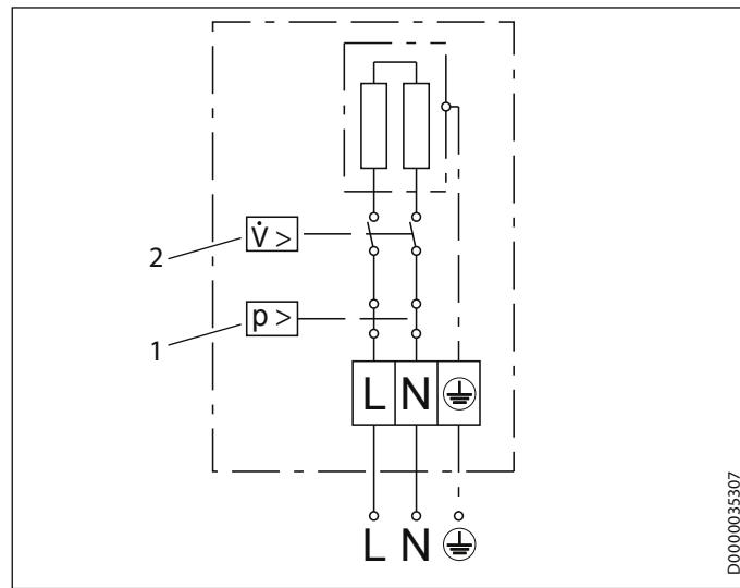
1 Предохранительный ограничитель давления
