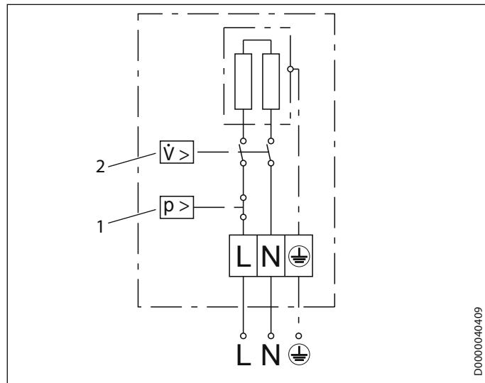
1 Предохранительный ограничитель давления
