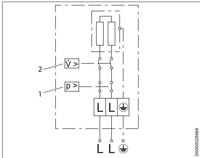
1 Предохранительный ограничитель давления
