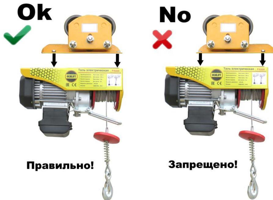
Установите мини таль на двутавровую балку. Стороны электрокаретки должны быть зафиксированы параллельно друг другу, не болтаться. Колёса каретки должны вращаться свободно без заеданий и без больших зазоров. Что бы таль не перекашивало весом двигателя в положении «без нагрузки» - выставьте и зафиксируйте отдельно стоящий ролик, который прижимает конструкцию к двутавру.
