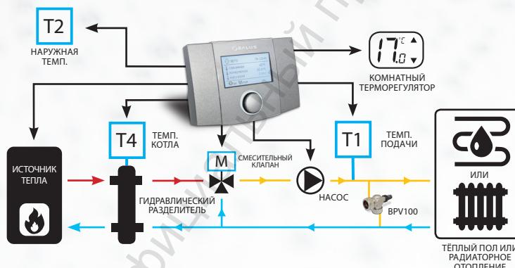
Погодозависимое регулирование температуры в отопительном контуре
